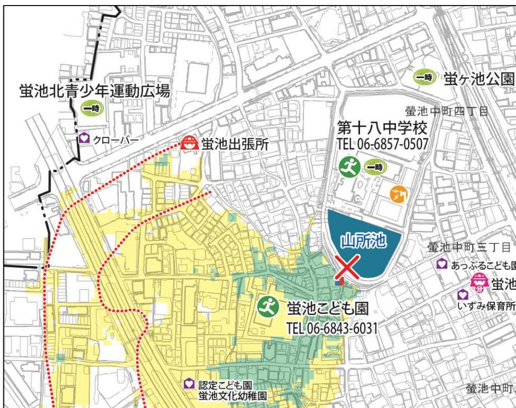
上記のため池は、令和元年度に行われた大阪府のため池耐震診断において、「大規模地震によって、貯水機能が損なわれる恐れがある。」と診断されましたが、安全対策として、貯水位の低水位管理を実施しており、大規模地震により想定される堤体の沈下が発生しても直ちに流出が起こらない水位に低下させています。
